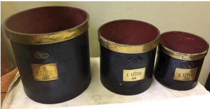
62 Droge maten, ijzer met messing band, 3 stuks, Miedema [631]
