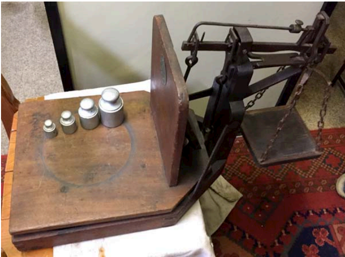
92 2 stuks evenaartjes (ijzer) + 2 balansschaaltjes [644]
