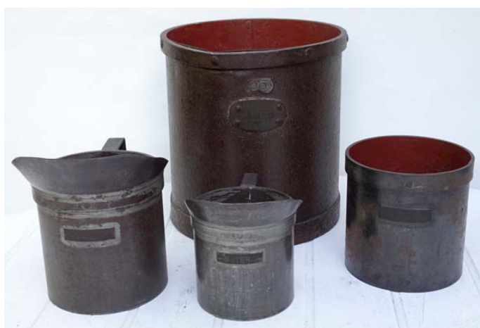
92 8x Set roodkoperen droge maten met messing banden, 1 dekaliter t/m 1/2 deciliter, fabr. Driesen, Maasdriel, ijkkantoor 3 = Arnhem, 1871 t/m 1926-'27. Maatjes van 1/2 en 5 deciliter (!) zijn iets eerder afgekeurd en daarna voorzien van een gat in de bodem. Complete set!
