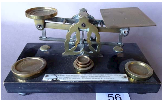
146 1x Frankrijk kleine gietijzeren Roberval balans met messing schalen, lengte 22,5 cm
