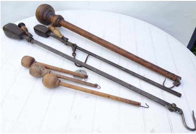
161 BENEFIET: Artsen zonder Grenzen: 1x Gelijkarmige balans, gebruikt als herijkbalans (reis) op het ijkkantoor Amsterdam. Het is een zgn. C-balans. Opschrift Beckers Sons, Rotterdam/Brummen
