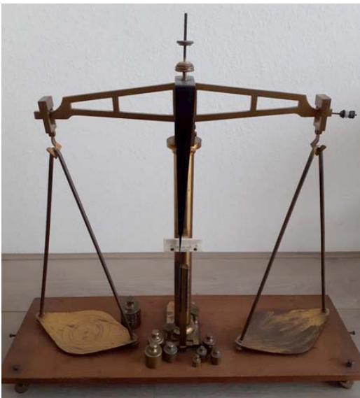
161 BENEFIET: Artsen zonder Grenzen: 1x Gelijkarmige balans, gebruikt als herijkbalans (reis) op het ijkkantoor Amsterdam. Het is een zgn. C-balans. Opschrift Beckers Sons, Rotterdam/Brummen
