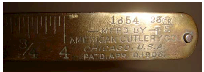
116 USA, 1x toonbankweegschaal met vernikkelde ovalen schaal, messing stang met schaalverdeling 0 - 4 lb en messing loopgewicht; fabr. American Cutlery Co, Chicago
