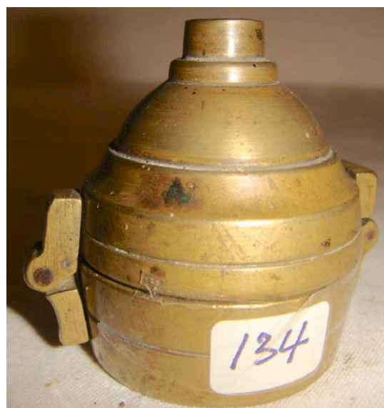
134 Rusland, 1x messing sluitgewicht met deksel 1 Funda (406 g) sluitertje ontbreekt
