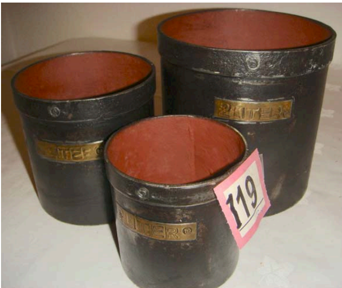
120 Spanje, 6x zinken vochtmaten, geijkt: Medio Decilitro; Decilitro; Doble Decilitro; Medio Litro; Litro en Doble Litro; fabricaat A.Maggi Barcelona
