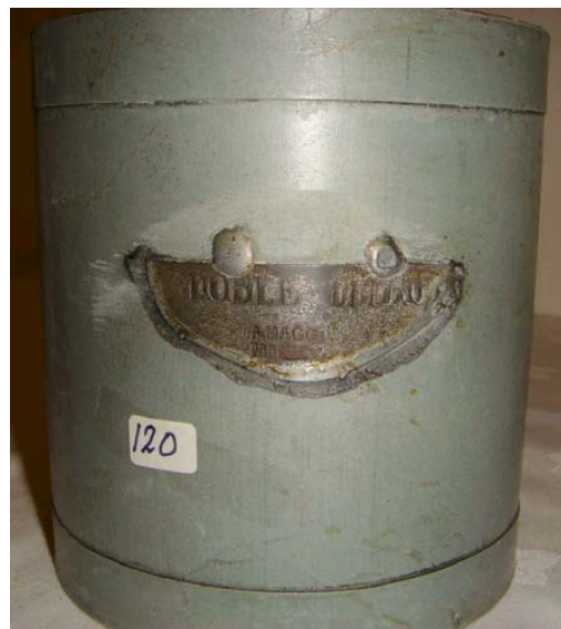
120 Spanje, 6x zinken vochtmaten, geijkt: Medio Decilitro; Decilitro; Doble Decilitro; Medio Litro; Litro en Doble Litro; fabricaat A.Maggi Barcelona
